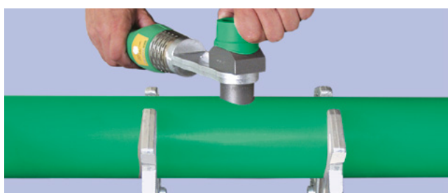
③ Вварное седло установите на насадку так, чтобы совпали метки на седле и на насадке. Прогрейте отверстие и вварное седло.
